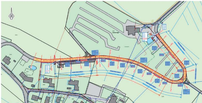
Im Zusammenhang mit dem Strassenprojekt hat das EKT für die Gemeinde ein EW-Projekt ausgearbeitet. Das Projekt sieht vor, ab dem Vorplatz Restaurant Chämihütte bis zur «TS Oberer Giger» ein Leerrohr PE 120 auf einer Länge von ca. 400 m zu verlegen. Zusätzlich soll ab der «TS Oberer Giger» die Parzelle GB-Nr. 1315 mit einem Leerrohr erschlossen werden.
