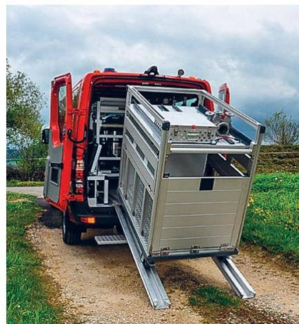
Mit diesen Rollcontainern kann auf dem Schadenplatz das entsprechende Material von Hand dorthin gebracht werden, wo es taktisch am Meisten nützt.
